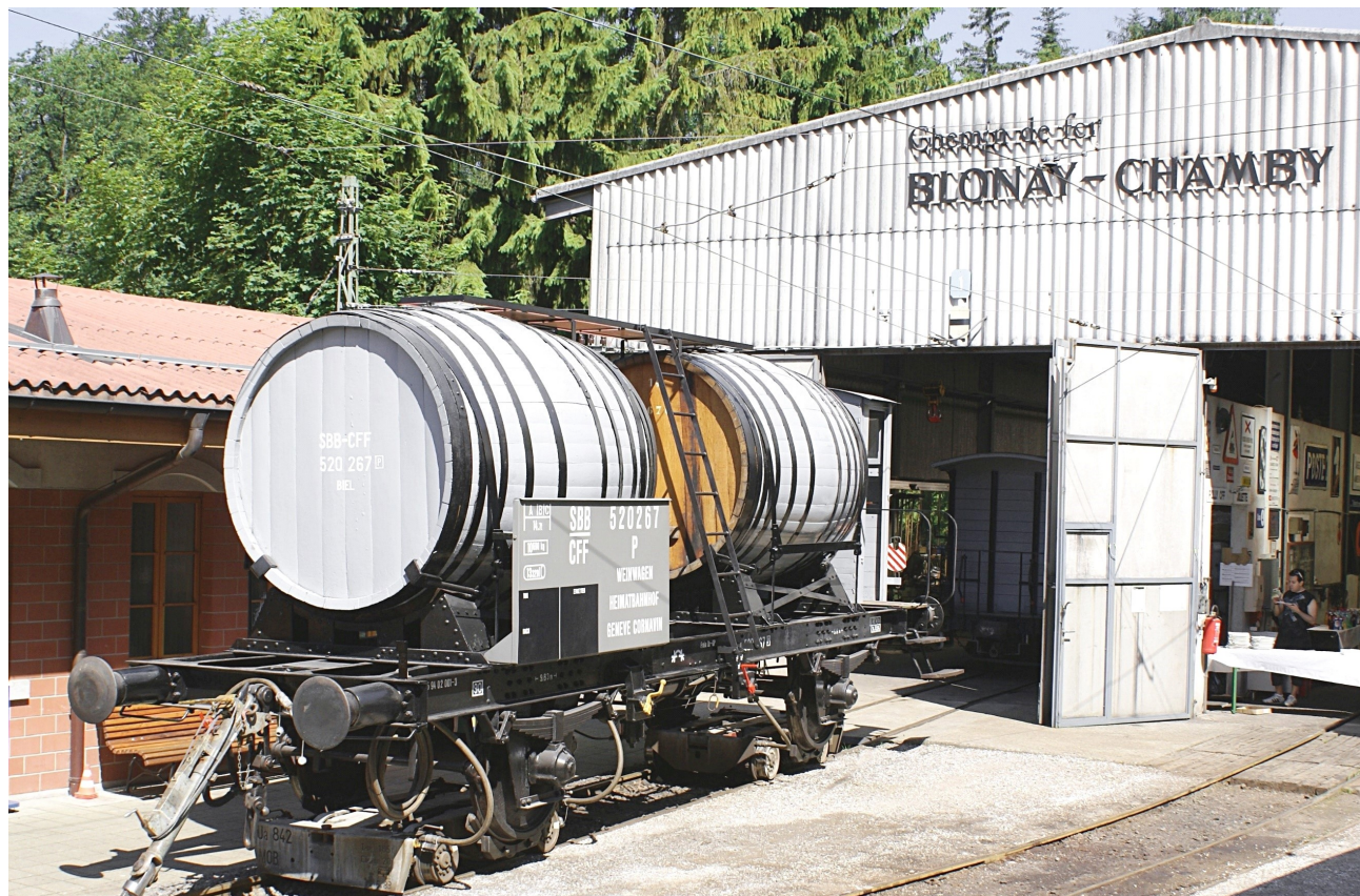
Carro bifoudre 520 267 P delle SBB-CFF su carrelli della Ferrovia Blonay-Chamby. Bollettino n. 361, agosto 2021. Foto E. Tripodi.
