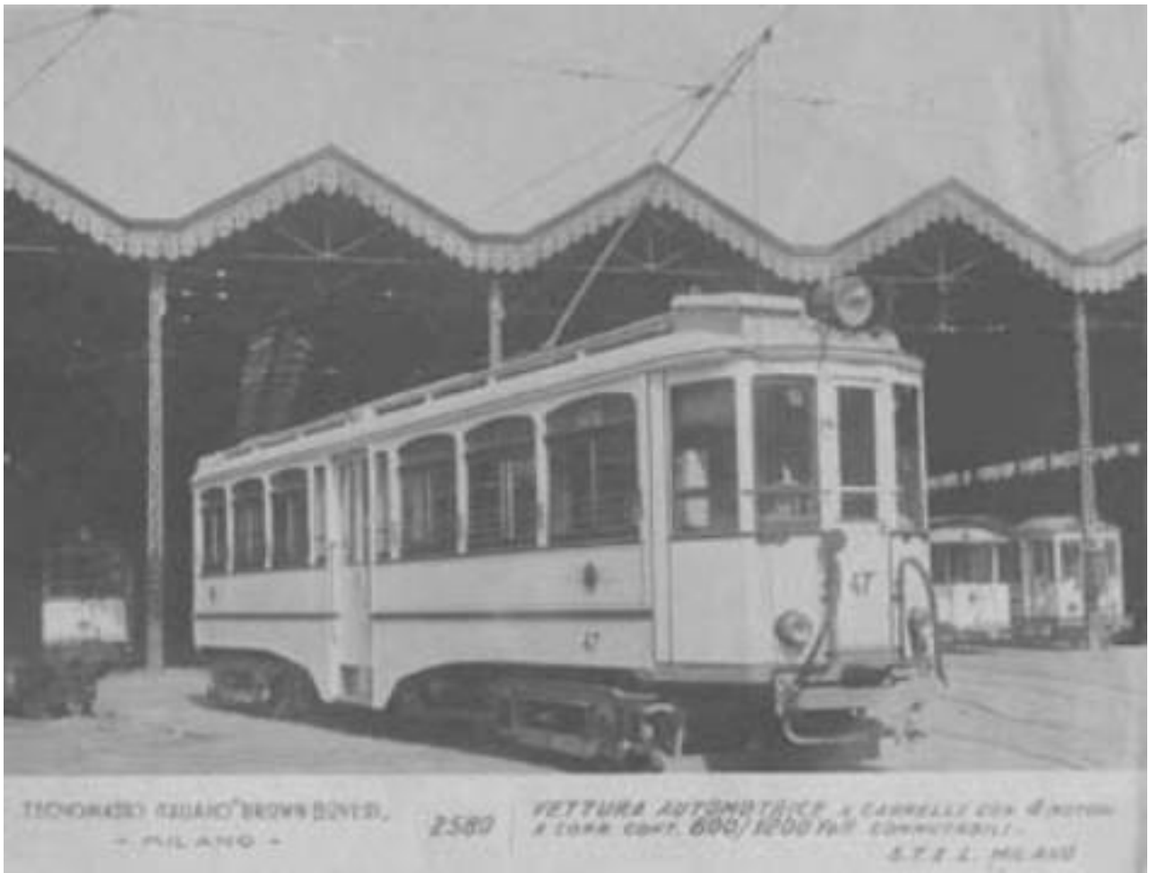
Una rara immagine della 47 ancora dotata di apparato bitensione posto a fianco del fanalone superiore. Nell'immagine è ritratta presso il deposito di Monza; dopo un breve periodo di prove, sarà inviata a fare servizio sulla linea di Desio. (foto TIBB).
