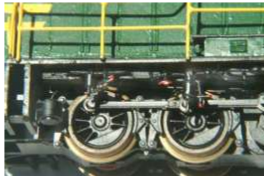
Vista laterale sinistra e particolare delle apparecchiature del sottocassa e della corona maggiorata.
