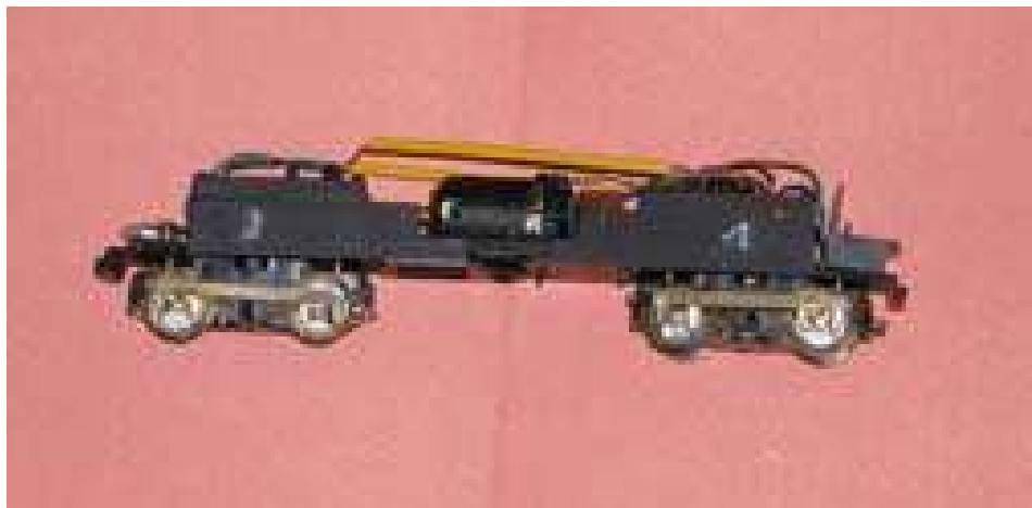
meccanica dell'E646: nuove fiancate dei carrelli
