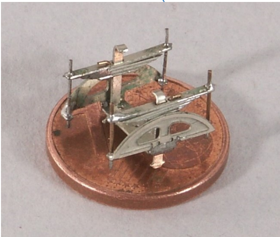
A sinistra: Telaio e balestre del carrello da montare solo per modelli da vetrina o per curve di raggio pressoché infinito. A destra: Tachigrafo con la bielletta di comando imperniata in un'astina di acciaio affogata in un foro al centro del perno di manovella; in alto la vetronite.
