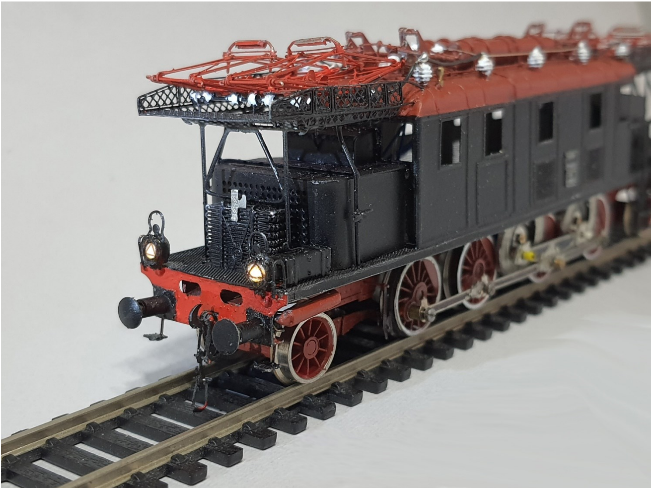
Prova di funzionamento dei fanali e vista di predellini, gancio doppio, serbatoio e isolatori vari.
