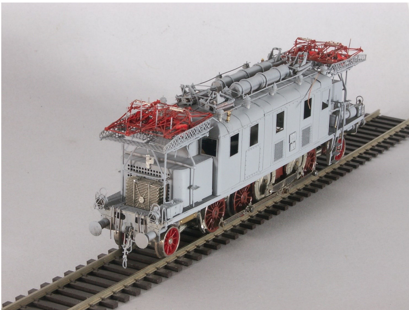
Vista \frac{3}{4} retro destro. In evidenza la serpentina di raffreddamento.
