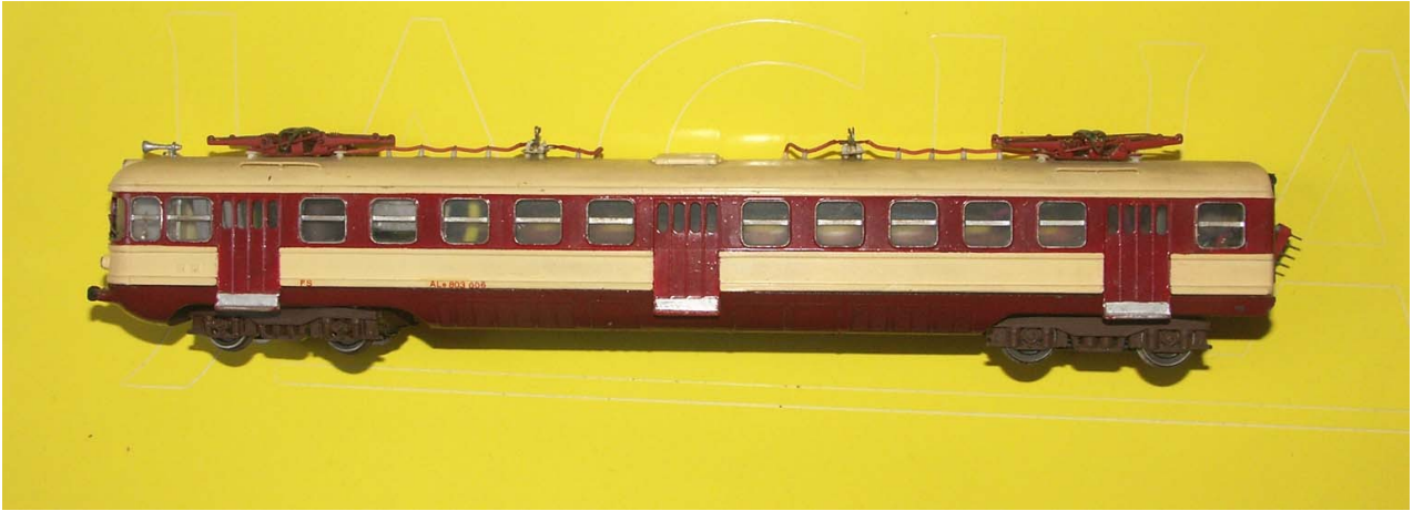
Motrice con i bracci dei pantografi rifatti, ora ben piatti a riposo, le condotte A.T e relativi scaricatori a corna.
