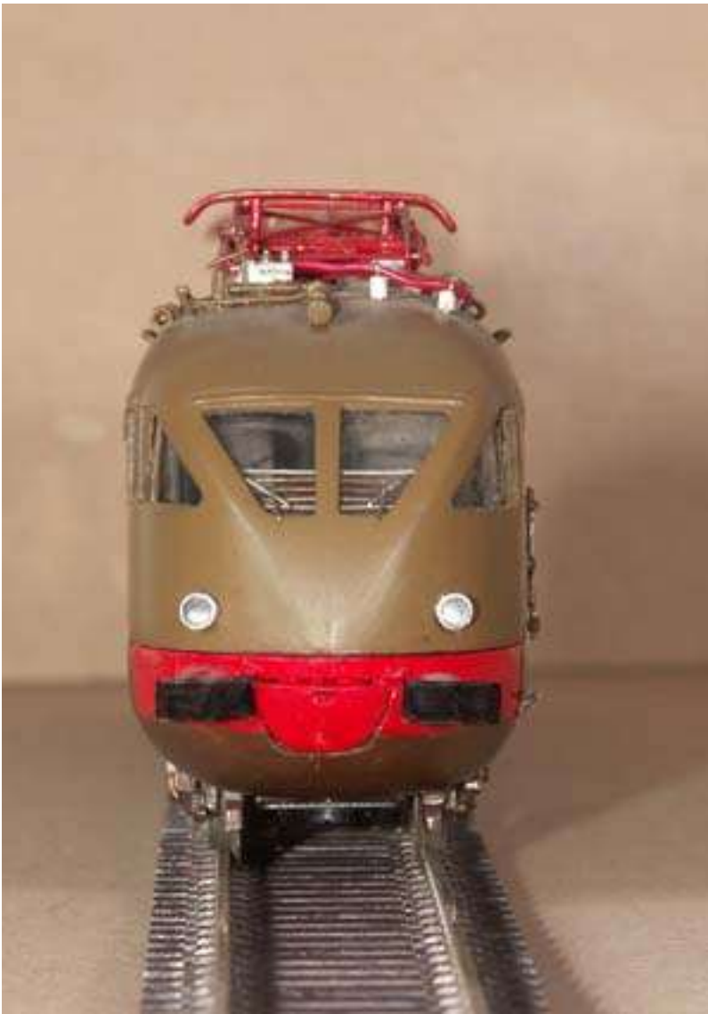
Foto 213 Testata aerodinamica con vano gancio apribile per le connessioni elettriche con altri mezzi accoppiati.
