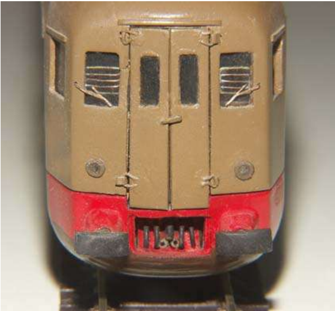
Foto 53 Particolare molto ingrandito delle connessioni elettriche del vano ganci (boccole sotto il gancio come descritto nel testo) e delle porte.
