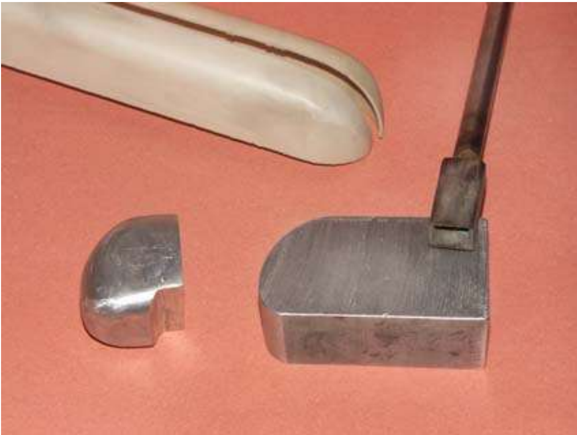
Foto 14 Esempi di testate e di punzone per finestrini.
