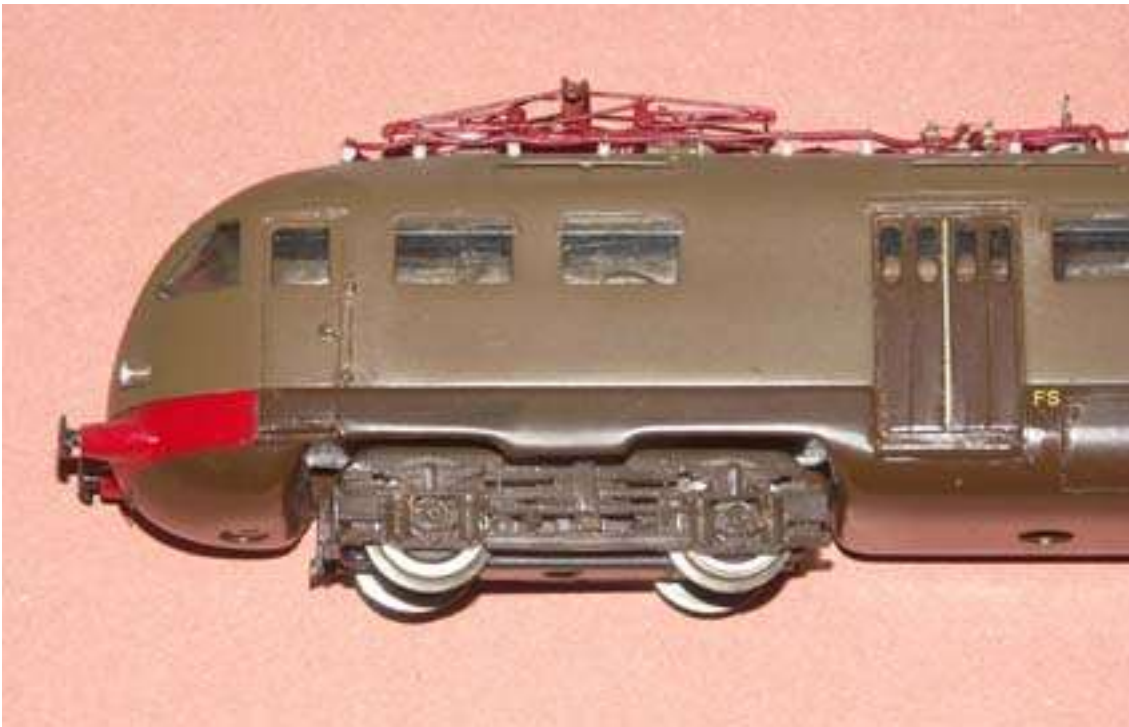
Foto 15 Carrelli della motrice con balestre doppie.
