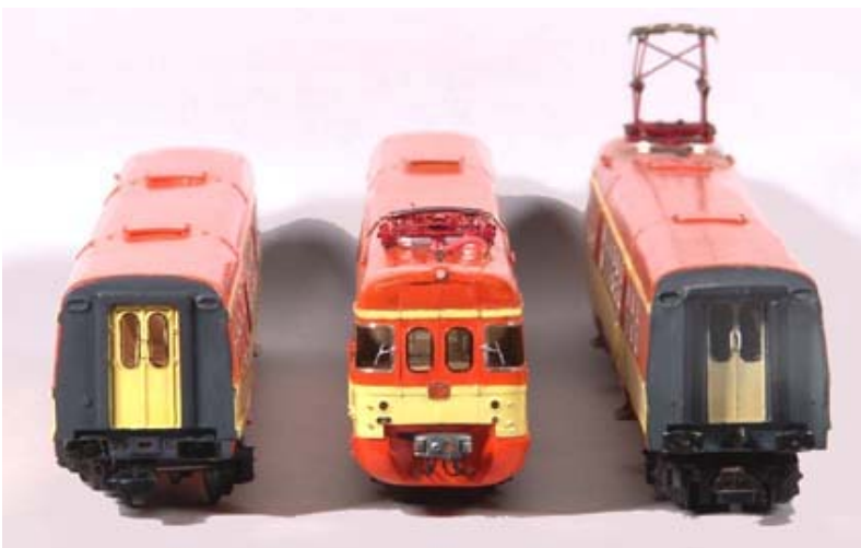
Vista delle testate anteriore e posteriore; notare il logo FS a televisore, l'attacco Scharfenberg Schaku con relative tubazioni e l'ammortizzatore laterale. La testata posteriore è comune anche ai rimorchi Le108.
