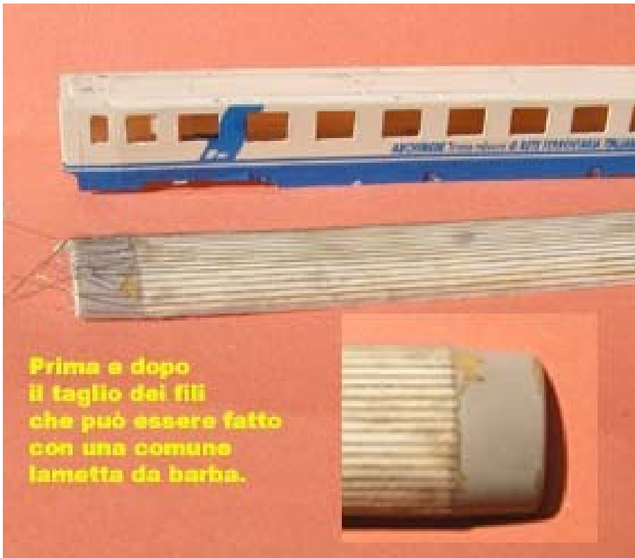
Costruzione del tetto cannellato
