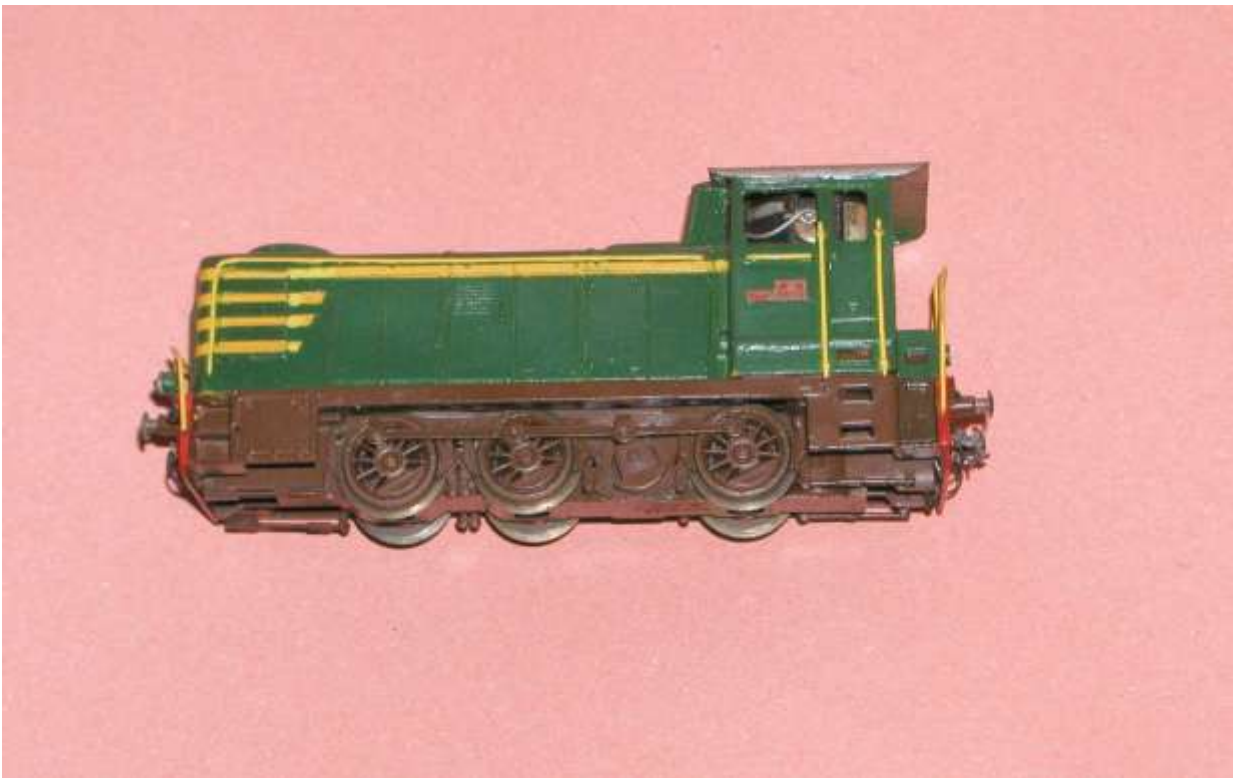
Foto 4 Vista laterale: si nota la fiancata del carro le cui curve sono state squadrate
