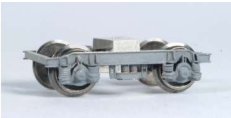
Carrello smontato con in evidenza la sospensione primaria e secondaria.
