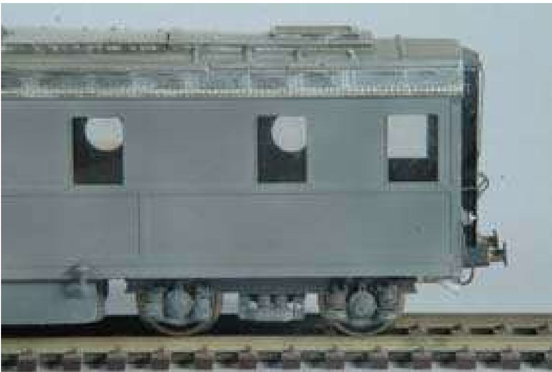
Particolare del carrello, della presa REC e del bocchettone di rifornimento del carburante presente su entrambi i lati del serbatoio.
