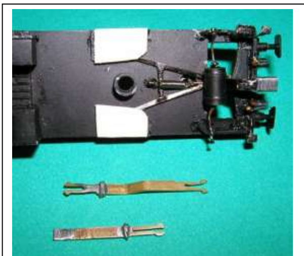
Timone di allontanamento e prototipi di barre di accoppiamento in piattina di ottone: per non ostacolare i movimenti del gancio il serbatoio del gasolio è stato spostato verso il basso (foto GDM)
