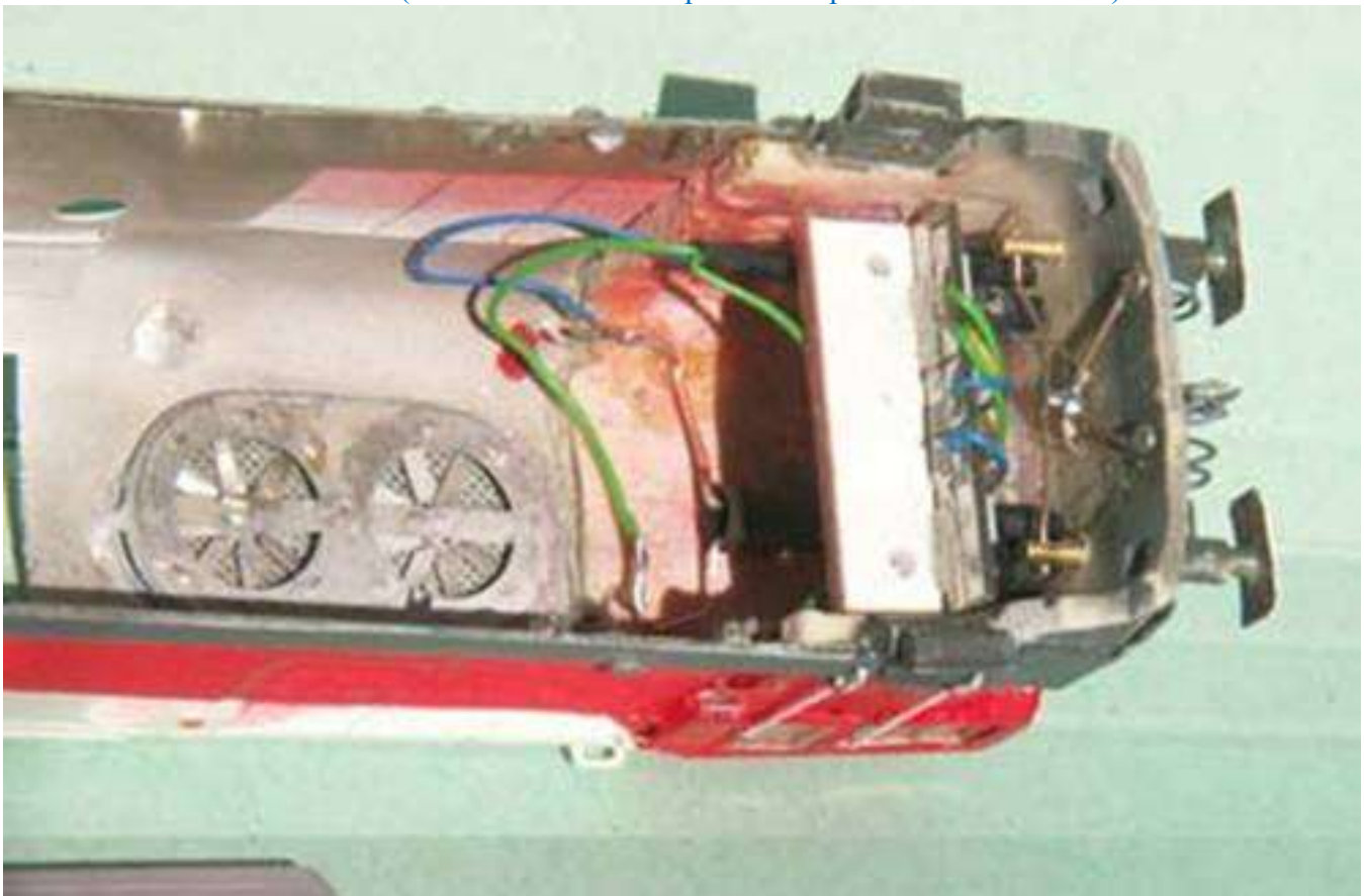
Particolare della piastra fari, del led per il terzo faro superiore e delle ventole
