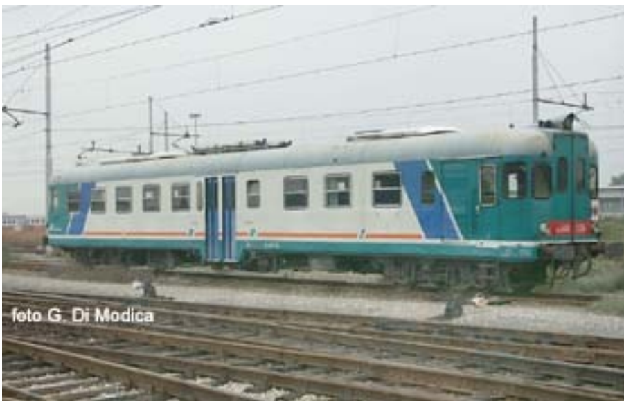
Aln 668 con condizionatori d'aria
