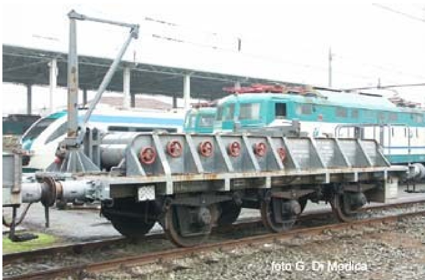
Carro controllo stadere a ponte
