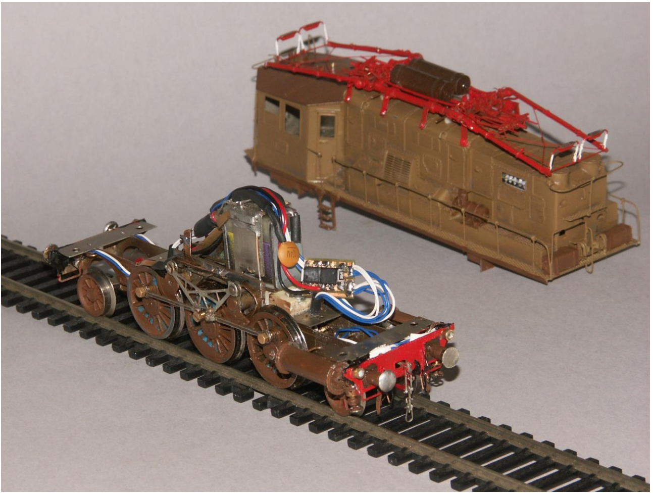
Prove elettriche dopo il montaggio del circuito stabilizzatore di corrente per i fari. Visibile anche il distanziale sotto il motore. Mancano ancora i diodi Zener di protezione.
