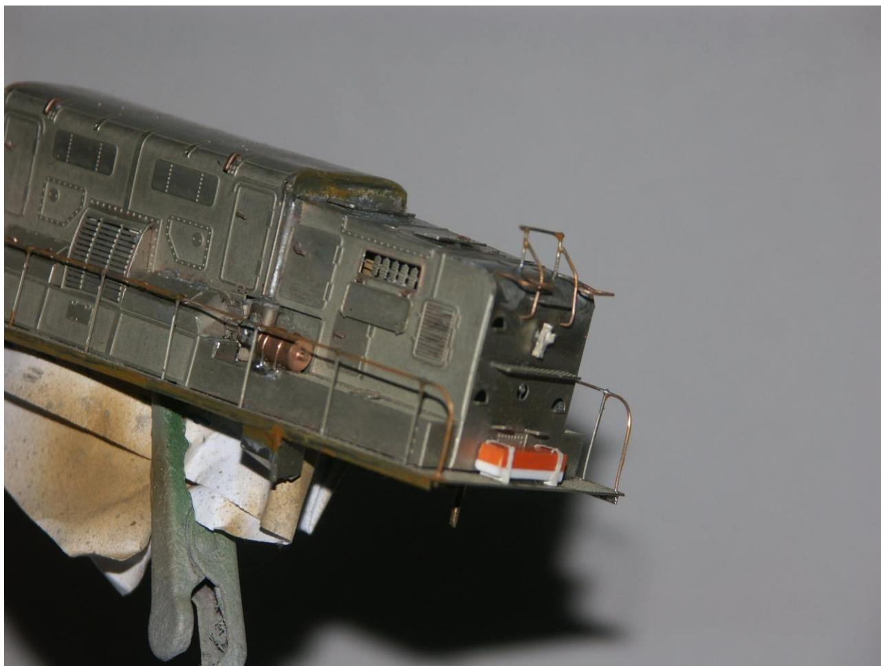
Particolare della binda in polistirene, del compressore e dei corrimani di origine per accedere all'avancorpo anteriore successivamente modificati
