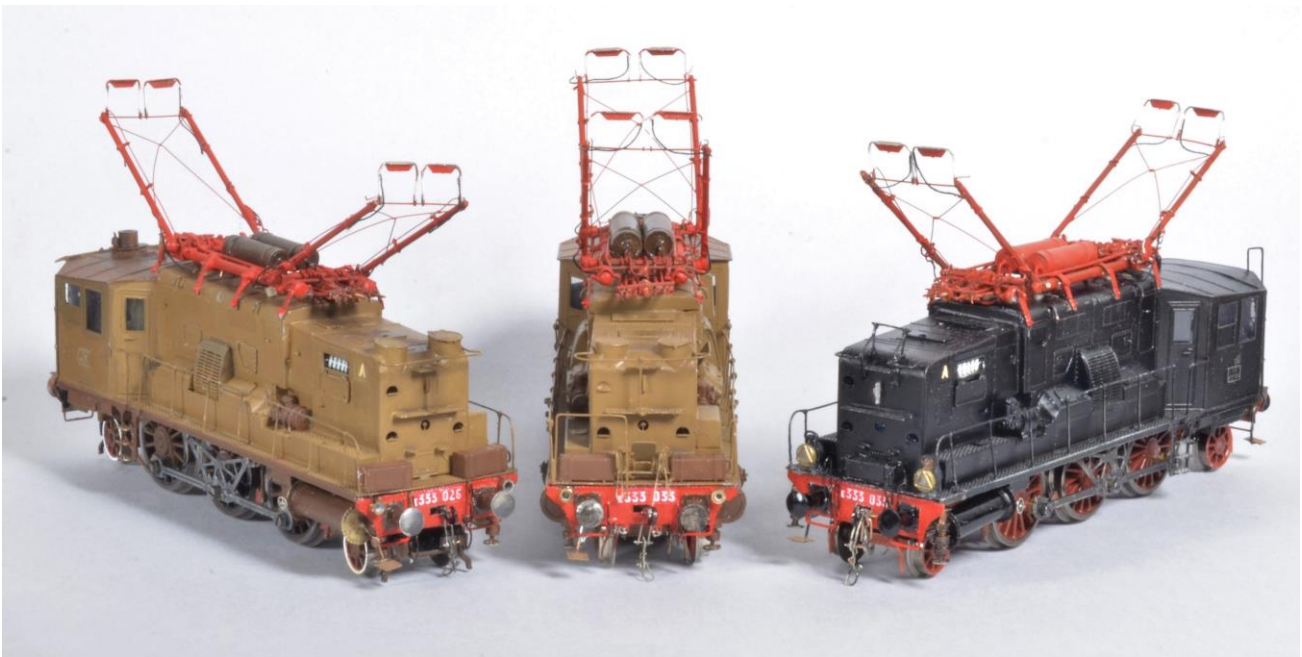
A sinistra la 026 finita, riverniciata di nero, al Museo di Pietrarsa; al centro la 033 trasformata atta al comando multiplo e a destra sempre la 033 in versione d'origine.
