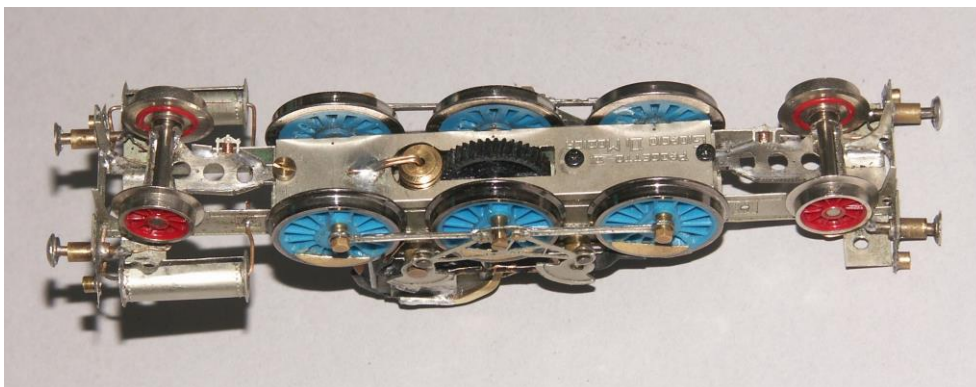
Telaio visto da sotto con la grossa ruota dentate su cui ingrana direttamente la vite senza fine del Treno Thomas. Si notano anche gli scambiatori di calore dal cilindro incompleto per non interferire col carrello.
