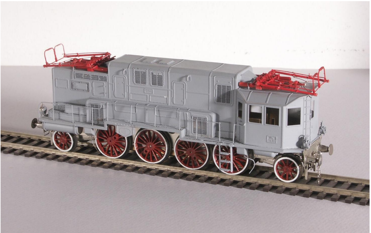
Vista lato cabina. Ovviamente i pantografi vanno fissati dopo la verniciatura della cassa.
