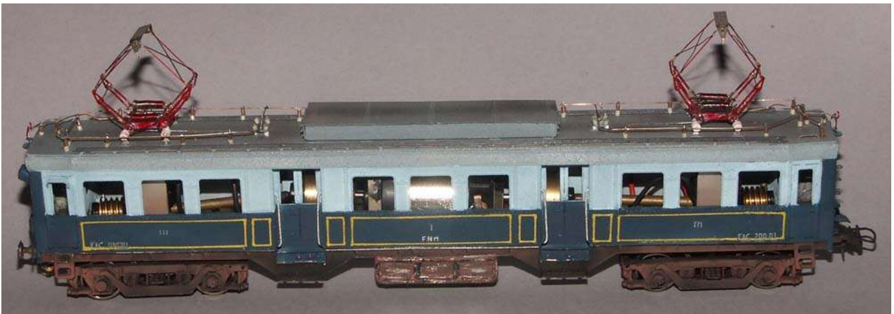
Elettromotrice EAC700.01 nella livrea d'origine; attraverso i finestrini si intravedono al centro il motore Bachmann e lateralmente i giunti cardanici allungati, i volani e le viti senza fine che potrebbero essere occultati inserendo delle tendine in carta dietro i vetri dei finestrini. Ma in genere questi particolari vengono lasciati all'estro e alla fantasia dei modellisti.
