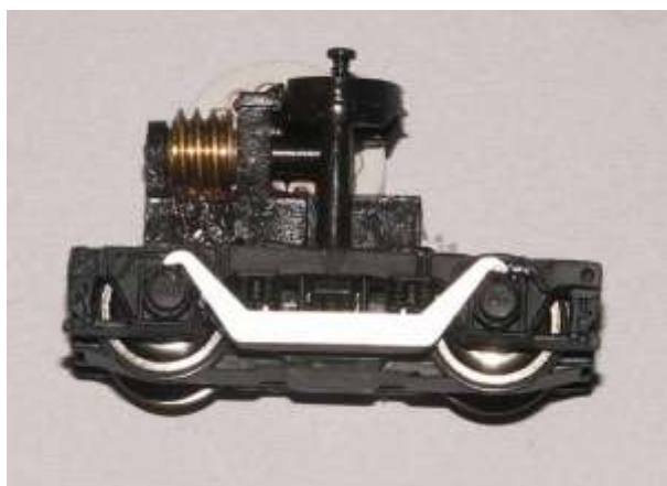
Carrello Bachmann con le fiancate già ridotte e col collo di cigno riportato.
