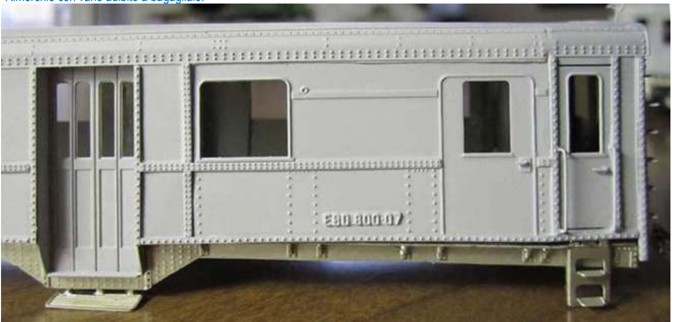
Particolare del rimorchio con porte pneumatiche a libro, vano bagagliaio con porta scorrevole e chiodature riportate.
