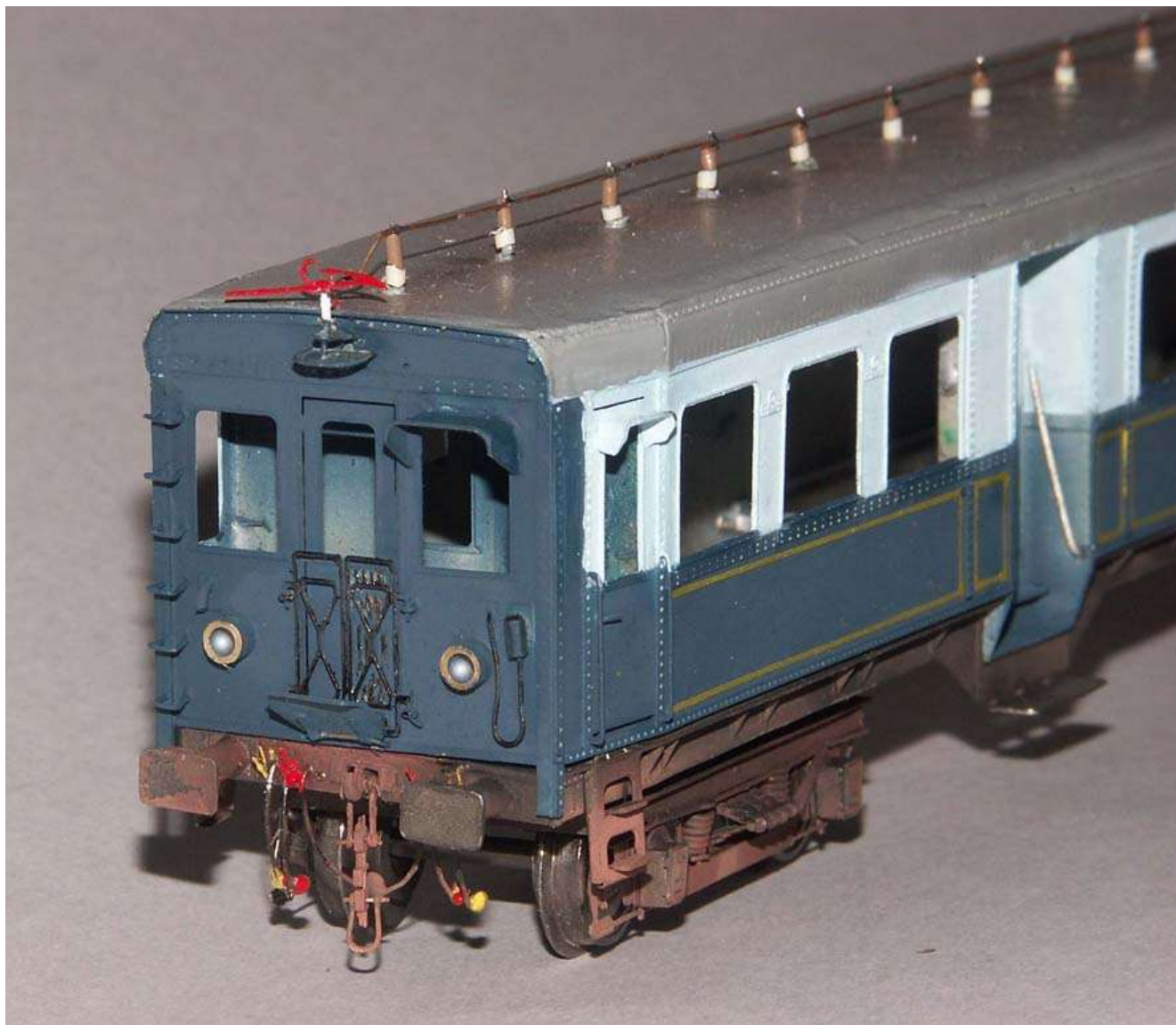
Rimorchio finito in livrea d'origine completo di isolatori bicolori, condotta A.T., "aragosta", fanali, terrazzini, telaio vissuto , ecc.
