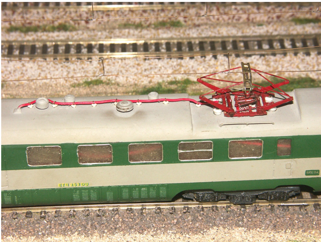
Vano pantografo, condotta elettrica e aeratore per il sollevamento del pantografo tramite la pompa.
