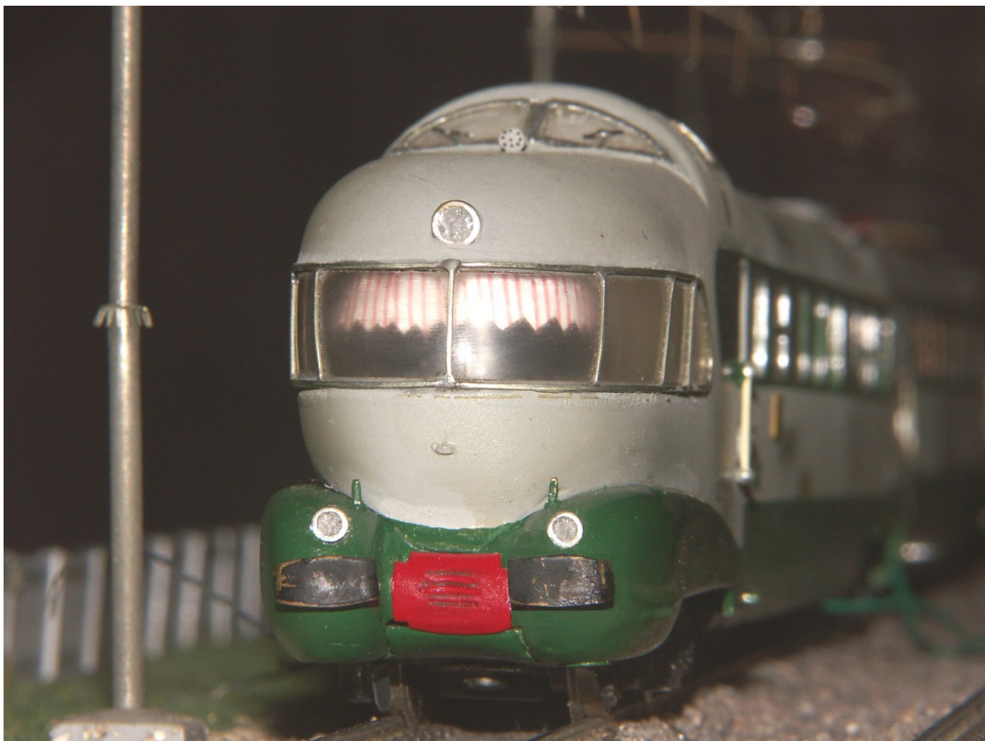
Vista della testata. Si notano le cornici dei finestrini in filo d'alpacca saldato, il portellone amovibile (del gancio e della condotta elettrica) e le tendine interne.
