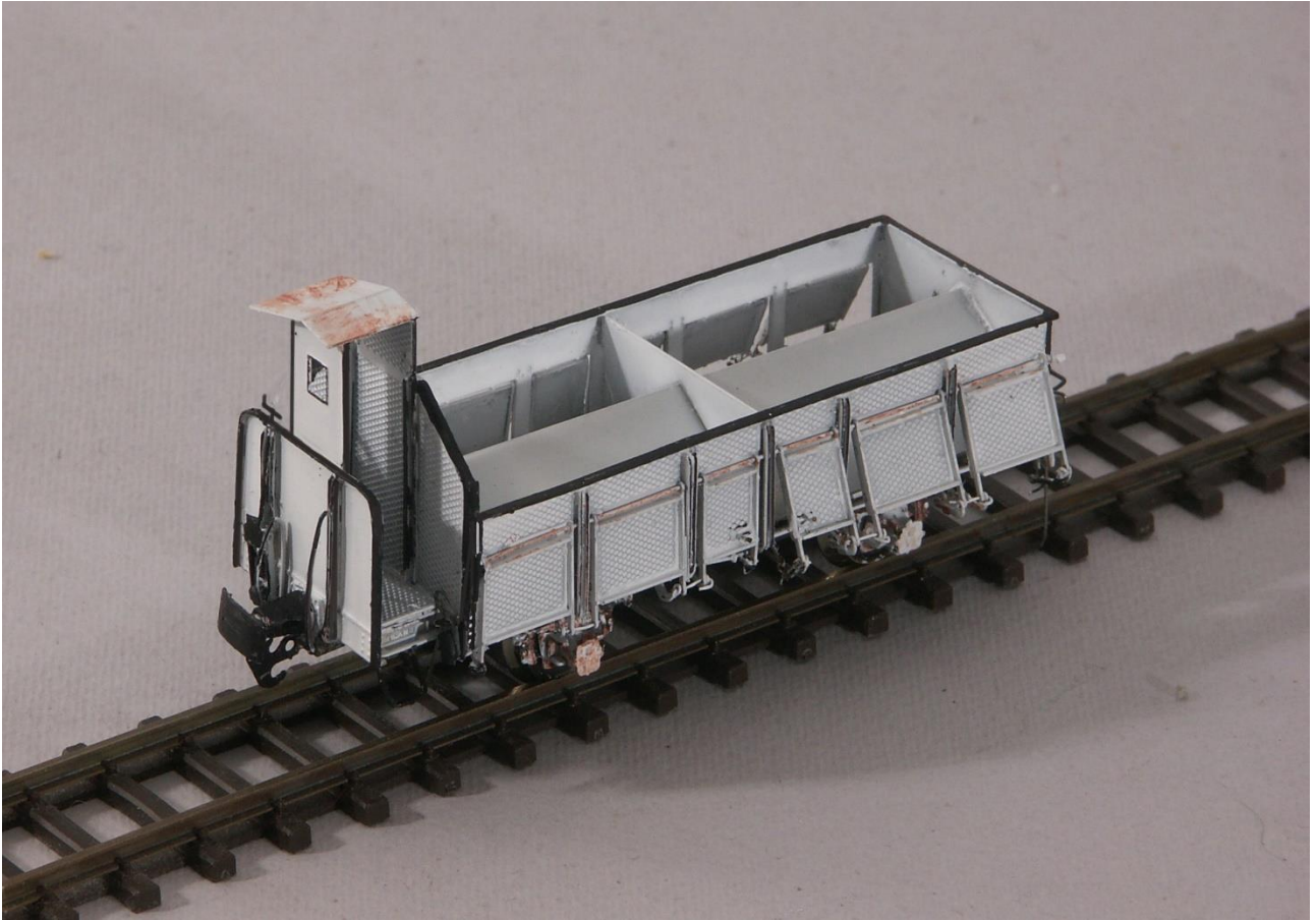
Nella vista dall'alto si evidenzia l'interno del cassone col divisorio e il pavimento inclinato per lo scarico a gravità.
