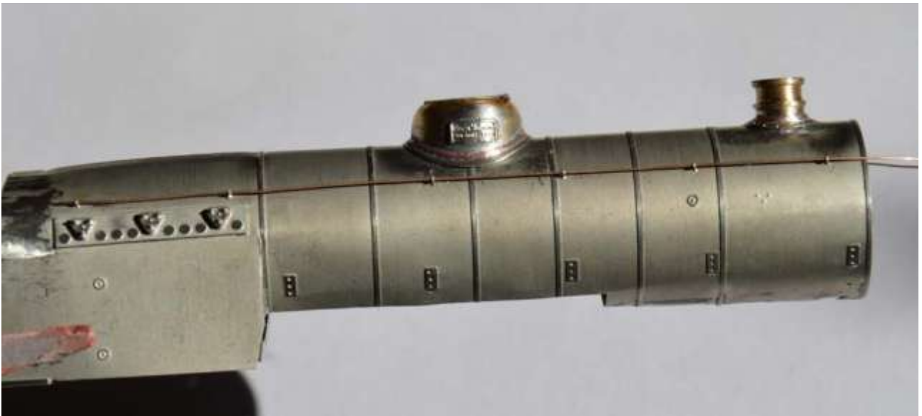
Caldaia in lamierino arrotolata su tondo (vedi testo) con parte posteriore, duomo, fumaiolo e portine d'ispezione già saldati.
