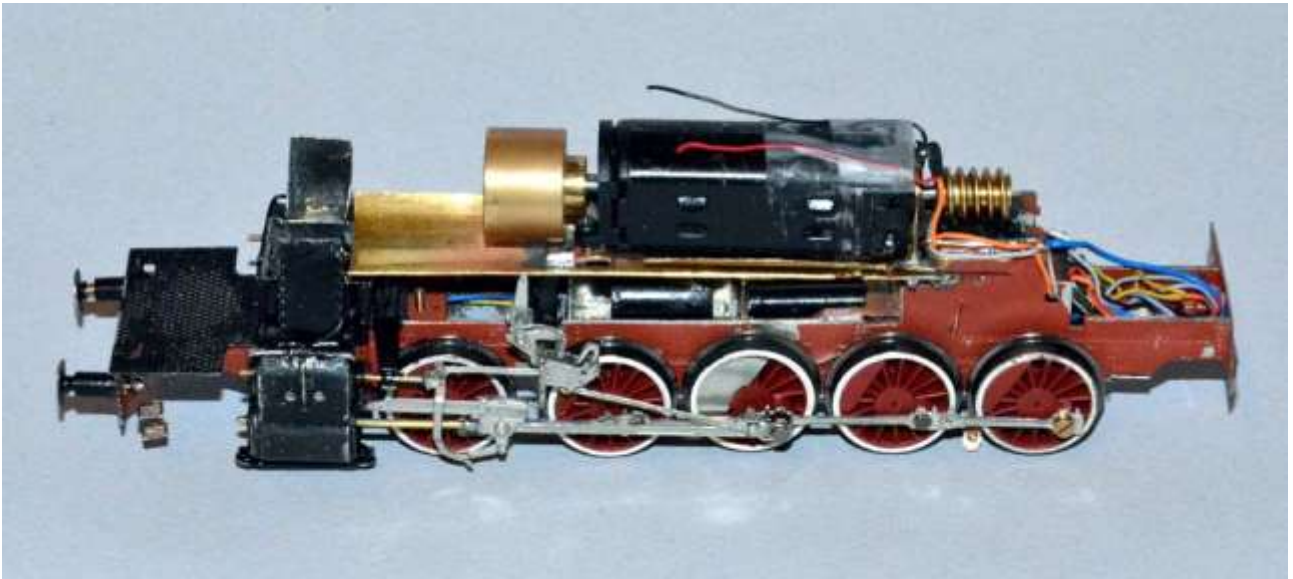
Prova del telaio col motore RR e (sotto) della nuova carrozzeria sul telaio RR.
