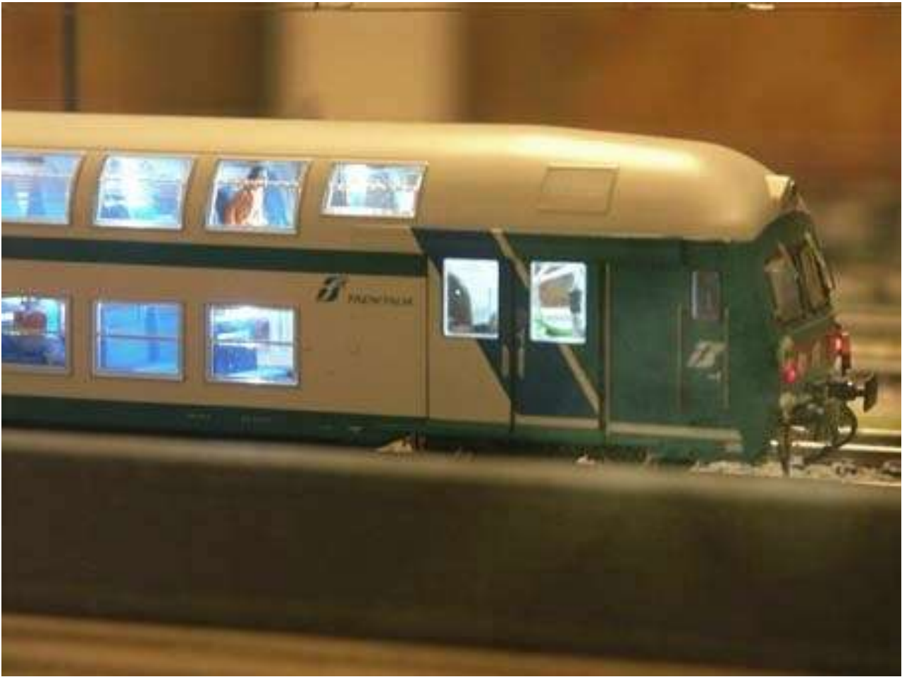
Particolare della pilota con i led rossi rifatti.
