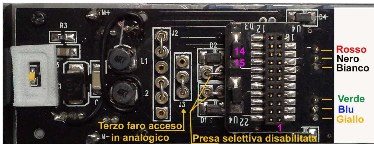
Circuito stampato sulla unità motrice con indicate le funzioni dei vari pin.
