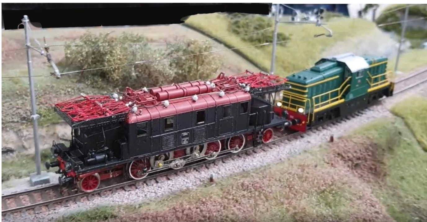
E472 trifase a frequenza industriale 10.000 volt
