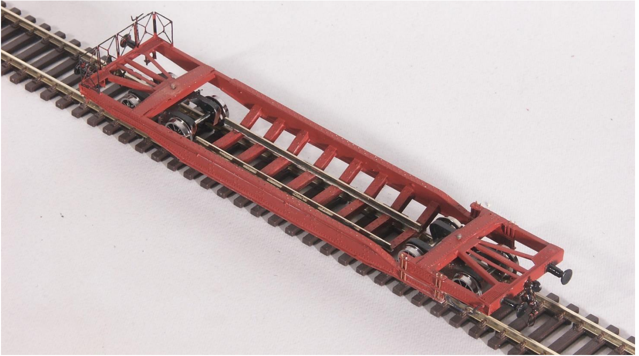
La vista di \frac{3}{4} evidenzia le pieghe di rinforzo dei due telai sovrastanti i carrelli.
