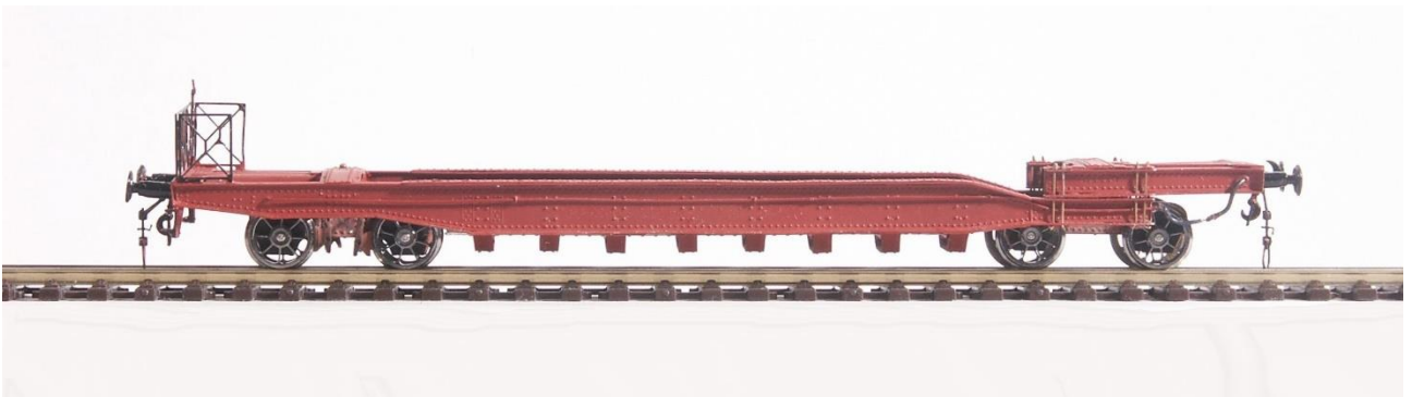
Vista laterale lato condotta del freno; ben visibile il raccordo in gomma (in questo caso con innesto a baionetta dei terminali) con il carrello sfilabile.
