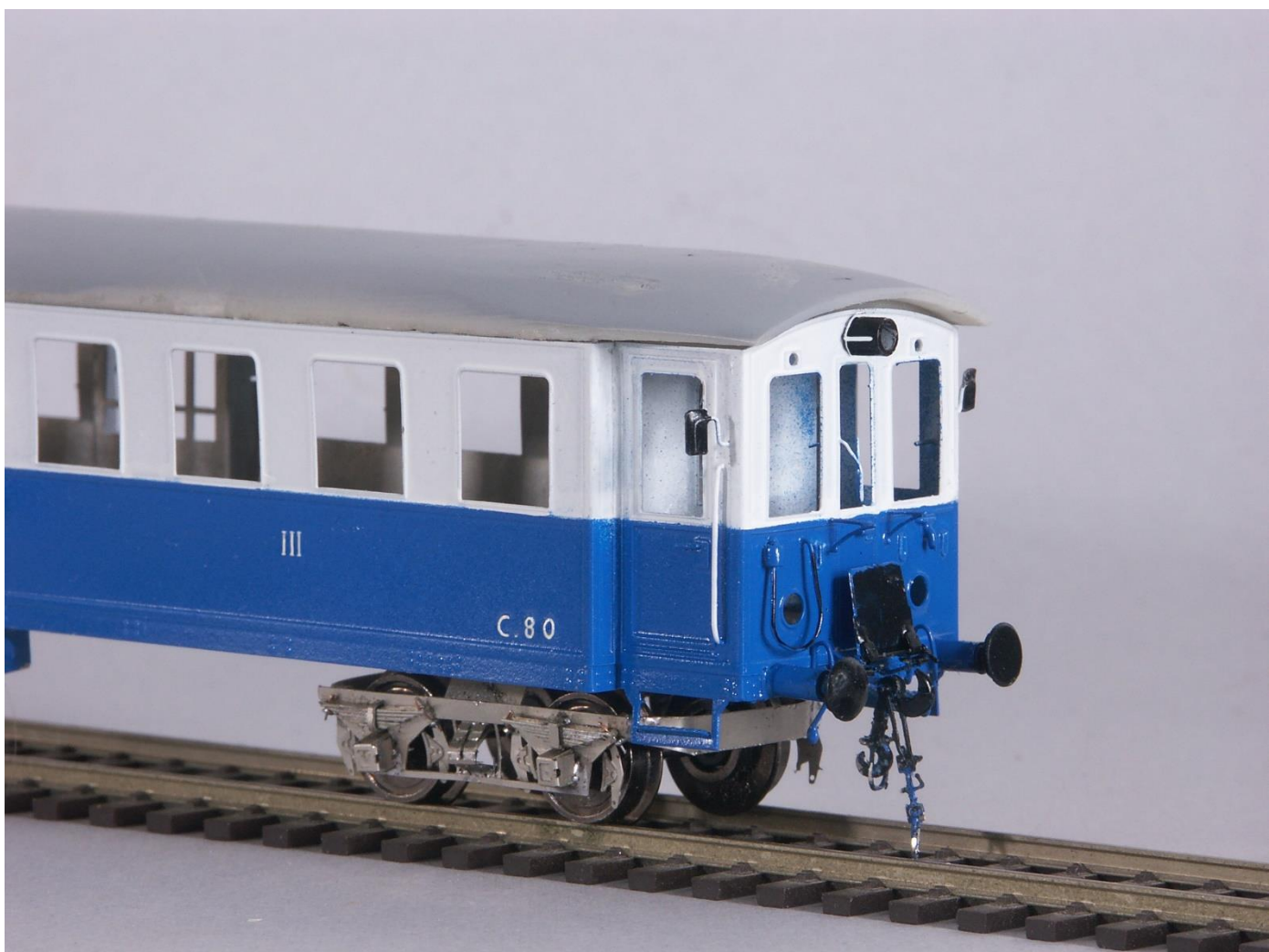
Frontale della rimorchiata pilota dei complessi bloccati; si nota il terzo faro, gli accoppiatori, il tergicristallo e gli specchietti per il macchinista.
