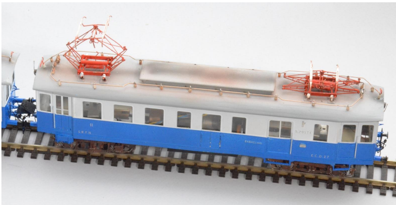
Vista dell'imperiale con i pantografi TIBB leggeri a doppio strisciante.
