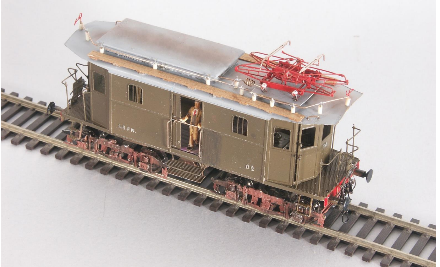
L'imperiale con la condotta AT, il vano reostati, i pantografi TIBB leggeri e le "aragoste".
