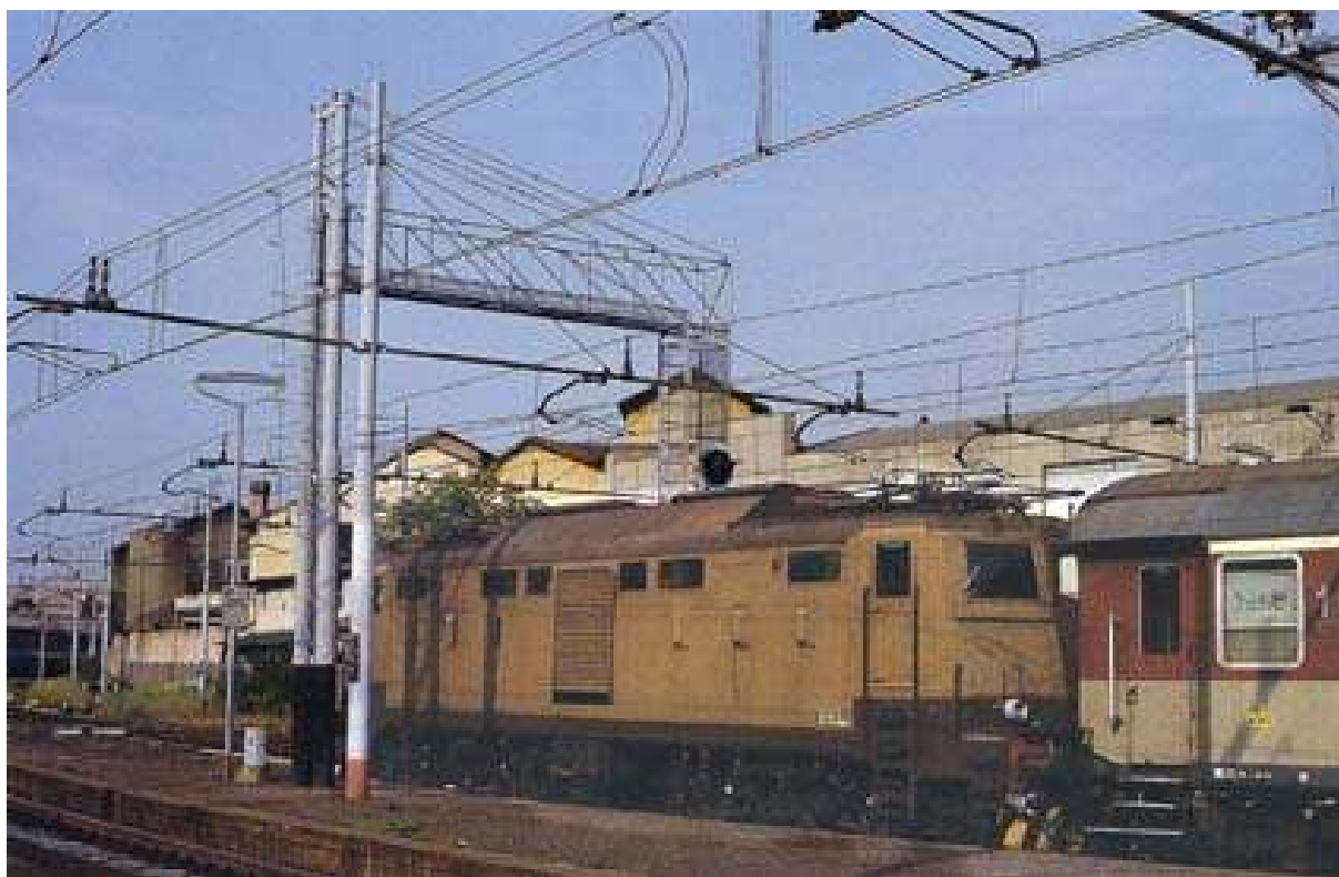
Vecchio segnale a forte sbalzo a una gabbia su traliccio tubolare a Milano P. Genova (maggio 1997): è chiaro l'impiego dei pali tubolari per linea aerea per il sostegno della passerella.
