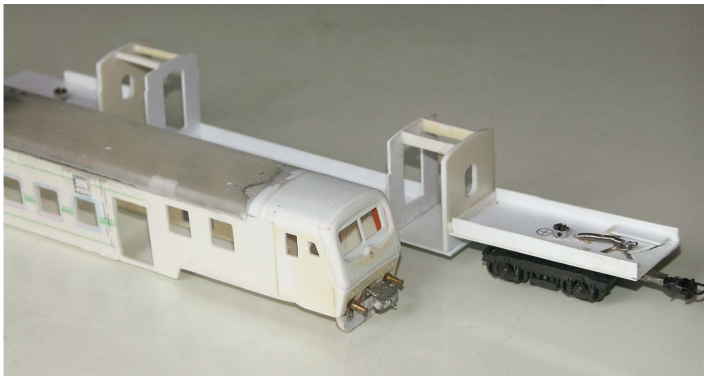
Testata aerodinamica, fiancate e telaio della carrozza pilota.
