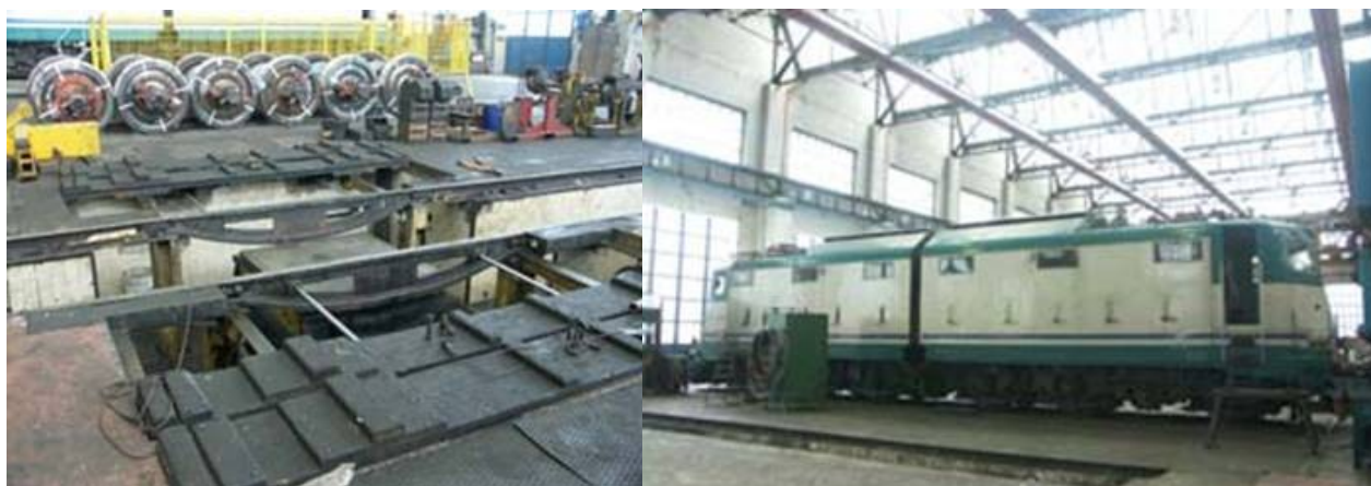
Fossa cala assi e recupero di pezzi dalla demolenda E 636 209
